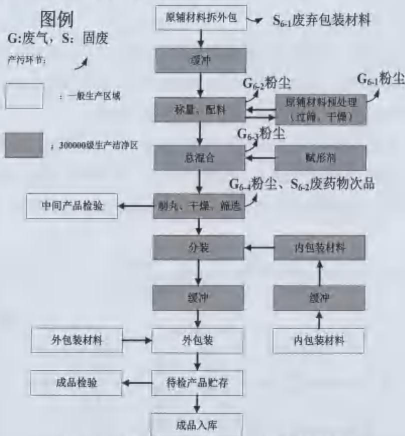
图 3-7 水丸剂生产工艺流程及产污环节
